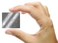
図1 光導波路型超小型レンズレスデジタルホログラフィック顕微鏡デバイス 通常の顕微鏡に比べ超小型化が可能 (22mmx25mm)
